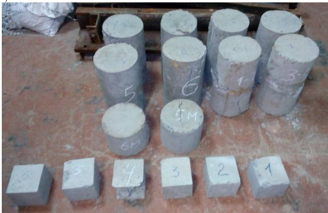
Рис.2 Дослідні зразки звичайного та обтисненого бетону
