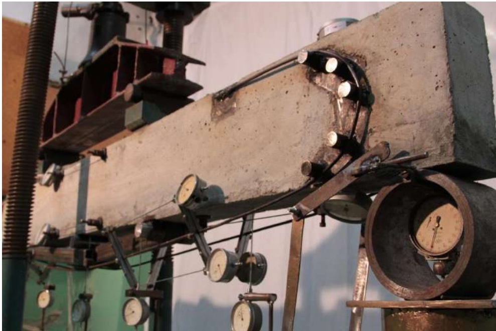
Рис. 1. Загальний вигляд підсиленої серії балок під час випробування
