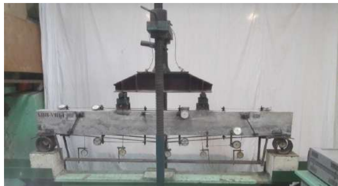
Фото 2. Загальний вигляд дослідної балки на стенді випробування
