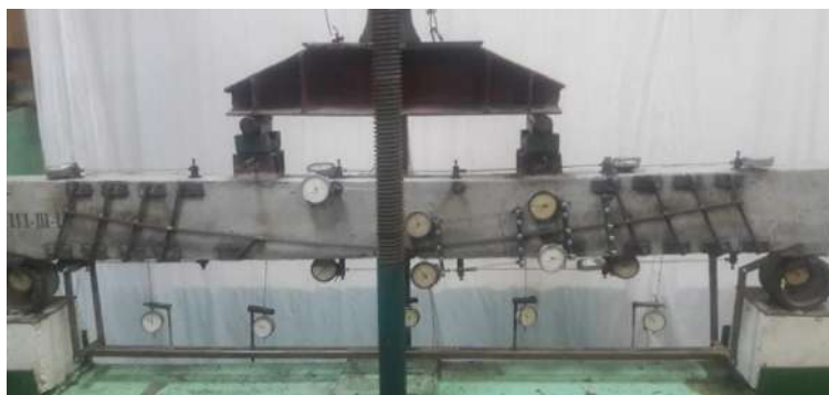
Рис. 1. Фото випробування підсиленої балки серії БПП-III-I
