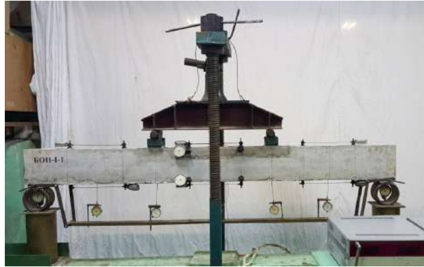
Фото 1. Загальний вигляд дослідної балки БОП-І-1 на стенді випробування
