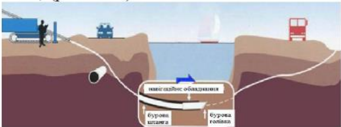
Рис. 3 Схема виконання прокладки свердловини за технологією ГНБ
