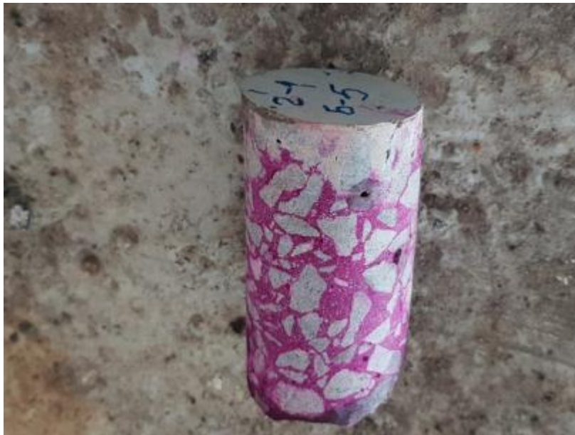
Рисунок 7 - Керн вибурений. Карбонізація бетону на глибину до 20 мм.
