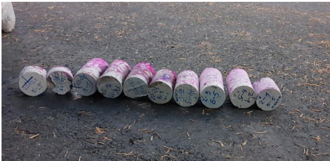
Рис. 2. Загальний вигляд вибурених кернів з тіла бетону балок прогонової будови для оцінки карбонізації.
