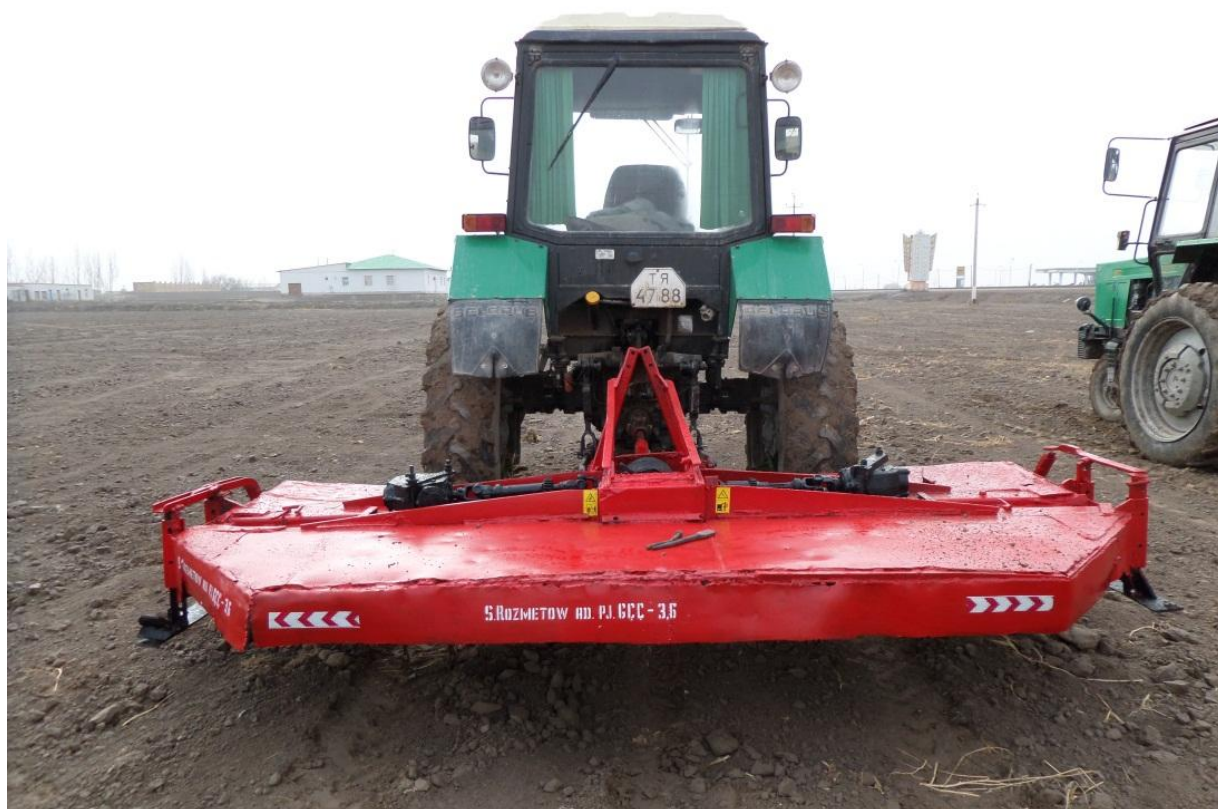
Рис. 1. ИСХ-3,6 измельчитель стеблей хлопчатника в полевых условиях
