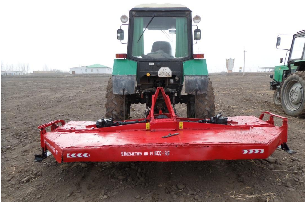
Рис. 1. ИСХ-3,6 измельчитель стеблей хлопчатника во время испытаний в полевых условиях
