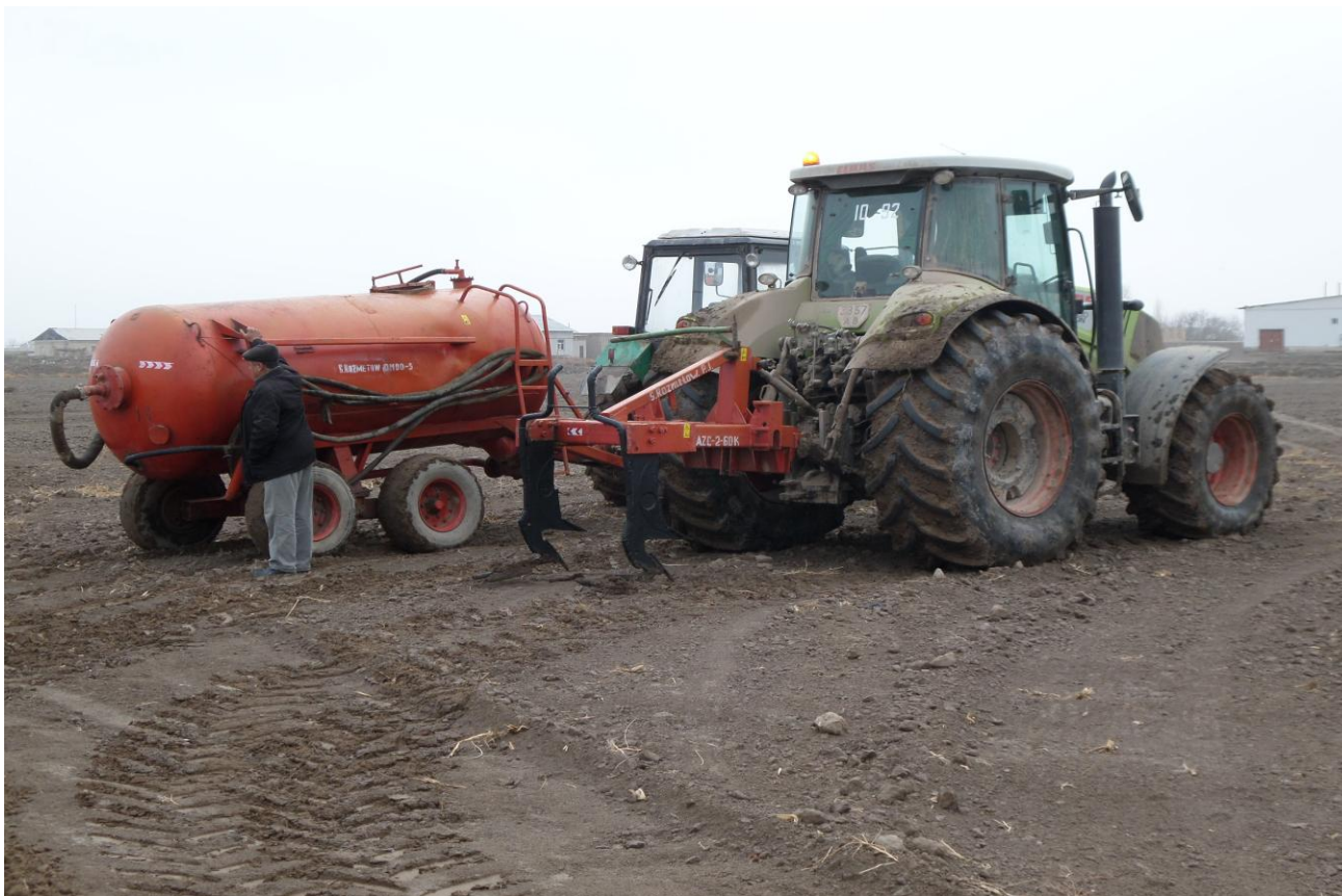
Рис. 2. Общий вид универсальной агромелиоративной машины НАД-2-60М в агрегате с трактором Case и емкость для внесения ЖОМУ в агрегате с трактором МТЗ-80Х в рабочем положениях
